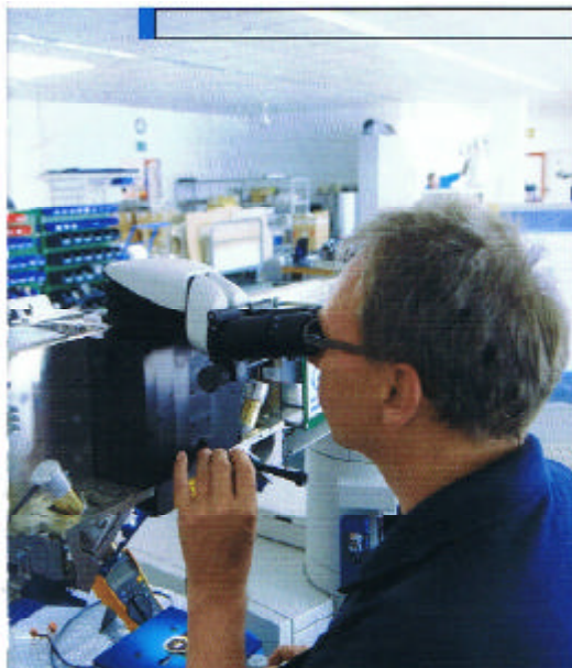
Schwind-Mitarbeiter (Peter Kosch) bei der Justage des Laserstrahls
