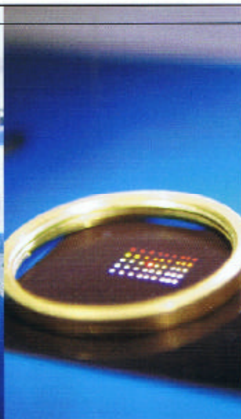
Testmuster zur Prüfung der Laserspot-Qualität
