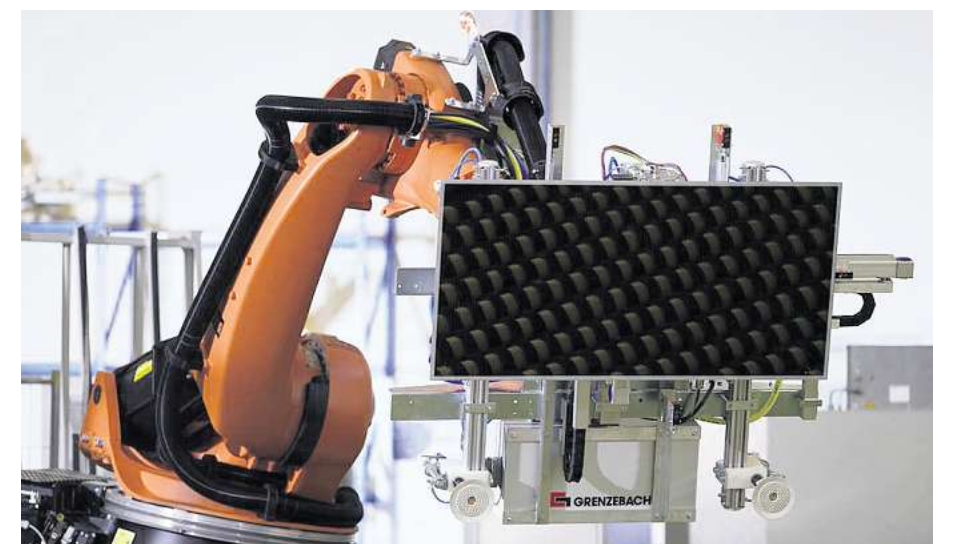
Scheibentransport wird automatisiert: Roboter übernehmen die Handhabung im Herstellungsprozess von Dünnschichtsolarmodulen. Foto: Grenzbach Maschinenbau
